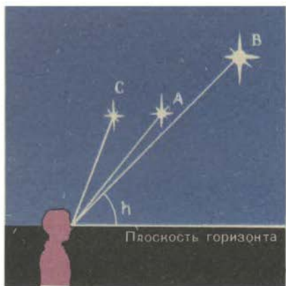
Рис. 5. Угловые измерения на небе и высота светила над горизонтом.
