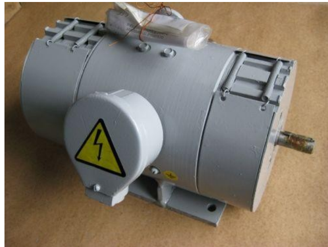
Рис. 4.5. Електродвигун 2ПН100L УХЛ4.
