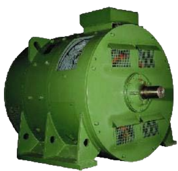
а - електромеханічний генератор
