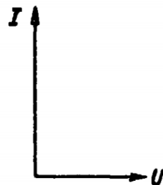
Мал. 10. Векторна діаграма напруги й струму з ємністю
